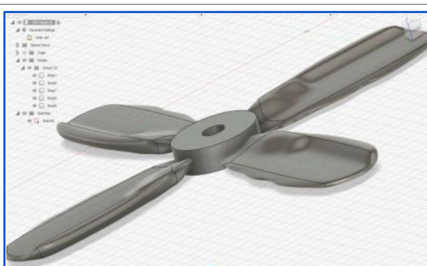
Sycamore Seed Fan blade (Method 1)
